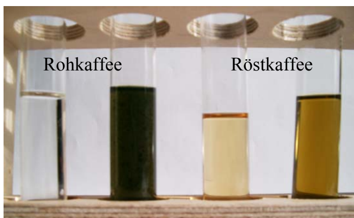
Gerbstoffnachweis mit Eisen(III)-chlorid (links jeweils die unbehandelte Kaffeelösung zum Vergleich)
